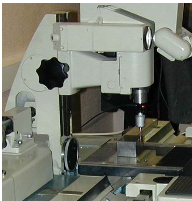
Рис.2. Микроскоп с контактной головкой
